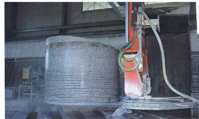
Nichts ist unmöglich: Auf der 5-Achsen-CNC-Brückensäge PFE Servo von Fickert & Winterling entsteht gerade vollautomatisch eine Kugel, die nach dem Abbrechen der Ringscheiben nur noch nachgearbeitet werden muss.
